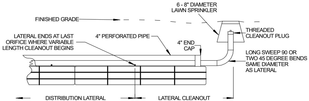
FIGURE 16: CONTOURED TRENCH PRESSURE DISTRIBUTION
