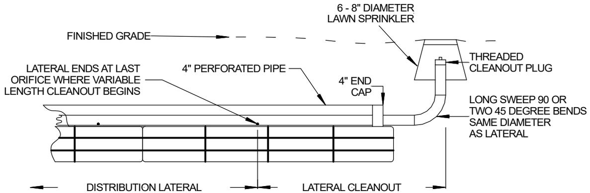
FIGURE 14: CONTOURED TRENCH PRESSURE DISTRIBUTION
